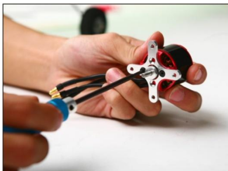
35.用M3沉头螺丝把十字架安装到电机上。
