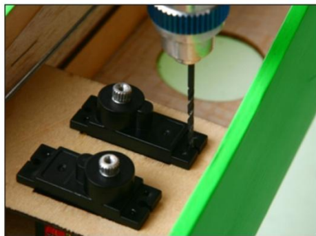
32.装上升降舵和方向舵机，用1.5钻头钻出螺丝孔，再拧上螺丝。
