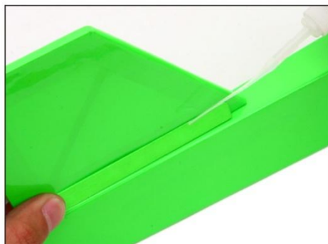
16. 用502胶水粘贴于垂直翼根部以达到加强作用。用同样的方法粘完另一边。
