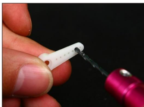
23. 在舵机摇臂上钻出2MM孔。
